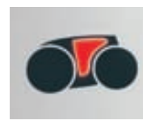
Indicador de filtro lleno. Nos indica cuando es necesario vaciar el filtro
