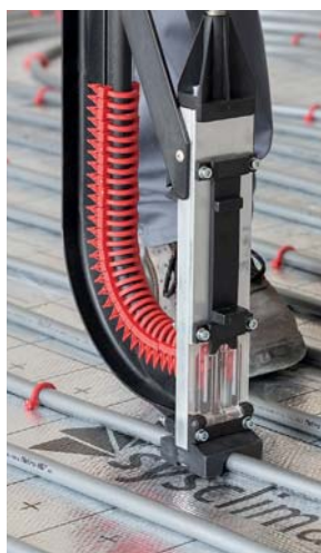
Grapa de fijación Sysclima 3D profesional para tubo Ø 16. Placas aislantes con espesor \geq 20 mm.
