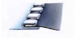
Detalle engatillado tipo LOC-4
