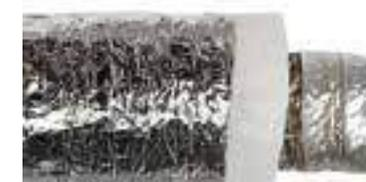
Tubo fabricado en multicapa de aluminio y poliéster, reforzado con una espiral de acero, recubierto con aislamiento de lana de roca y una capa de aluminio. El rendimiento cumple con los estándares EN13180. Aislamiento clase A1, certificado según EN 13501-1. Precio por unidad.
