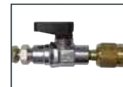
Manguera flexible para el vacío se utiliza para la conexión de la bomba y el grupo manométrico con conexiones 1/4" SAE, completo de válvula, tubo con barrera de nailon, O-ring en PTFE de 1/4" SAE, presión máxima 60 bar.
