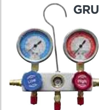
Grupo manométrico con manómetros llenos de glicerina. El líquido de llenado del manómetro de glicerina amortigua cualquier pico de presión, impacto o vibración y protege el mecanismo de manómetro. Los manómetros de glicerina son adecuados para una amplia gama de aplicaciones, especialmente en casos de procesos de choque y vibración.
