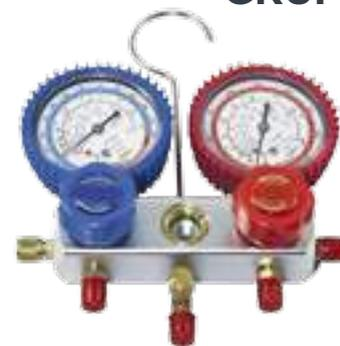
Grupo manométrico de 2 vías con indicador de flujo - con manómetros de tubo bourdon - en seco - gancho de anclaje - conexiones de 1/4" SAE.
