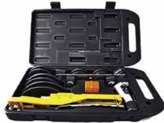
Para tubos de cobre recocido con Ø 3/8" - 1/2" - 5/8" - 3/4" - 7/8".
